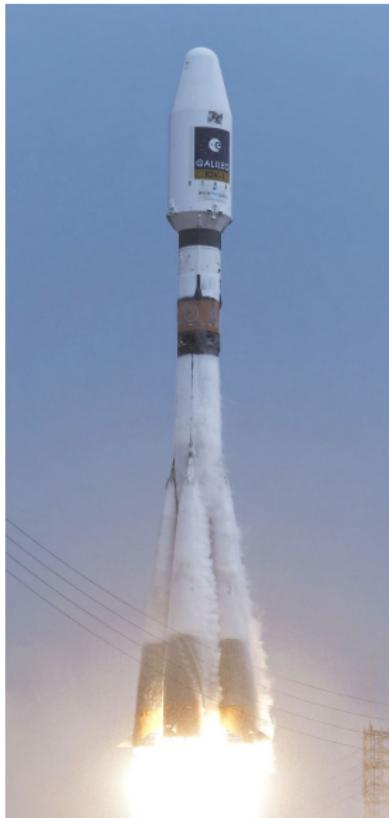
Головной обтекатель – элемент конструкции ракеты-носителя, предназначенный для защиты полезного груза от внешних тепловых и аэродинамических нагрузок при транспортировке полностью собранной РН или космической головной части к стартовому столу и во время атмосферного участка выведения РН.
