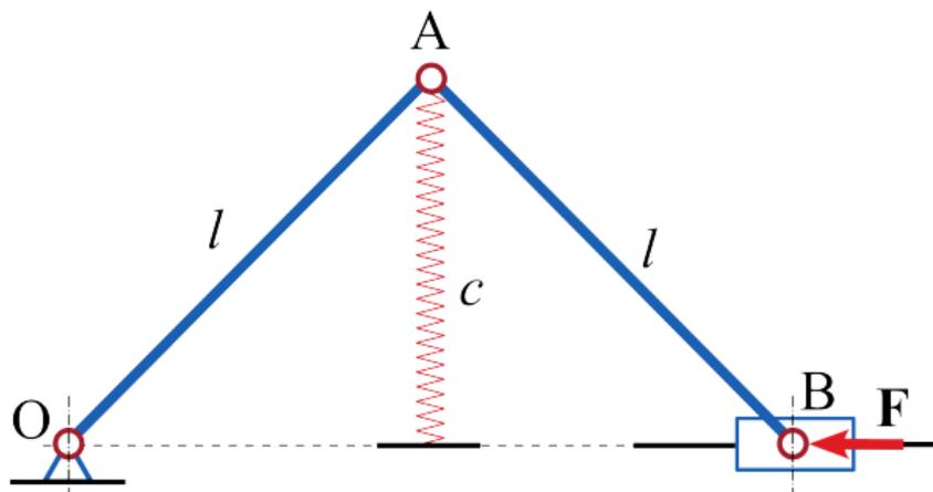
OA и AB – однородные стержни одинаковой массы и длины, ползун B – материальная точка. Сила  $F$  - постоянна, жесткость пружины  $c$  известна.
