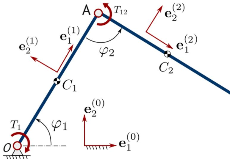
$T_1, T_{12}$  – моменты пружинных приводов – торсионов.
